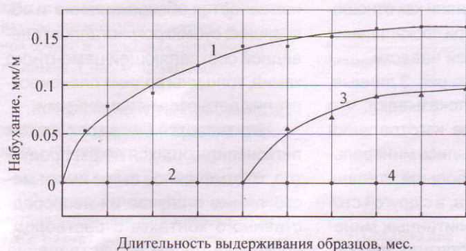
Рис. 1. Деформации набухания раствора
