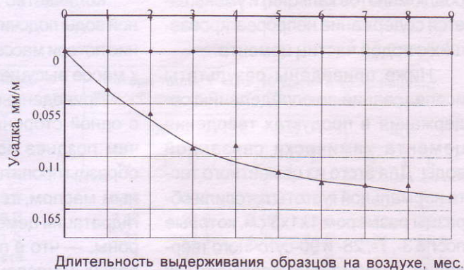
Рис. 2. Усадочные деформации раствора
